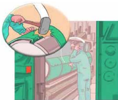
1 Вставить широкую часть замка бандажа с одной стороны в паз крепления на цилиндре
