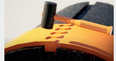
Montar los dientes progresivamente, golpeando el mazo hacia abajo hasta completar el puzzle.
