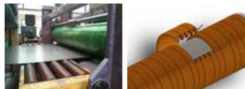
En alternativa a la revulcanización, es posible desarrollar piezas intercambiables, fáciles de instalar y desmontar, y evitando los viajes de ida-vuelta de los cilindros usados. Ejemplo foto: Sistema de tensado para bobinado de chapa.
