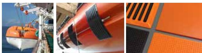
Planchas para facilitar el deslizamiento de botes salvavidas sobre el costado del buque. Material adaptado para ambiente marino.
